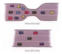
En resumen, la resistencia eléctrica mide lo difícil que es para los electrones moverse por un material. En un circuito, usar materiales con baja resistencia es como conducir por una carretera despejada, mientras que materiales con alta resistencia dificultan el flujo, como un atasco en una carretera estrecha.
