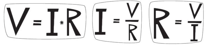
Ejercicio: Un circuito simple está formado por una pila de \(9v\) y una bombilla cuya Resistencia Eléctrica es de \(3\varOmega\).
